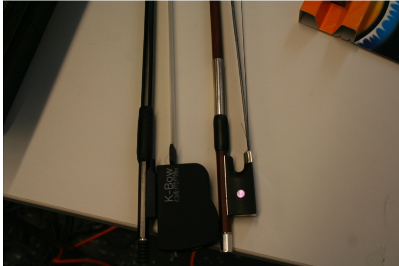
Figur 18 Til venstre: K-bow med en plasthylse som beskytter elektronikken. Til høyre en vanlig fiolinbue
