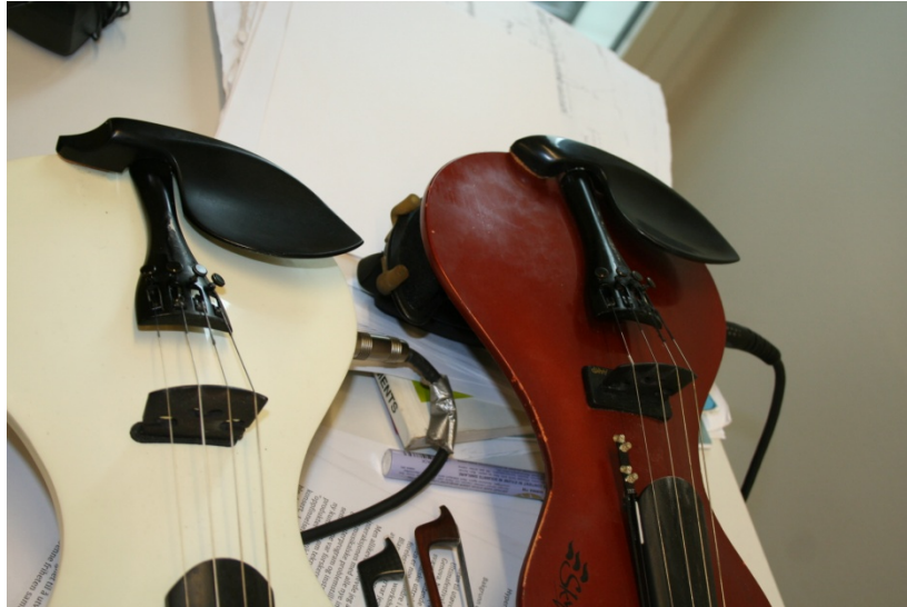
Figur 17 Mine to el-fioliner. Til høyre sees K-bows elektronikk med infrarød sender, påmontert min Skyinbow elektriske fiolin. Til venstre en el-fiolin uten elektronikk
